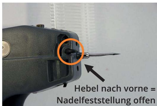
Nachdem die Nadel fest eingeführt wurde, ist der Verriegelungshebel (siehe oben rechts) wieder behutsam entgegengesetzt zu drehen. Ist das nicht möglich, ist die Nadel noch nicht richtig in der Nut. Evtl. die Nadel wieder herausnehmen, etwas drehen und zurückstecken. Jetzt sollte der Hebel zur Nadelfeststellung nach hinten gedreht werden können.
